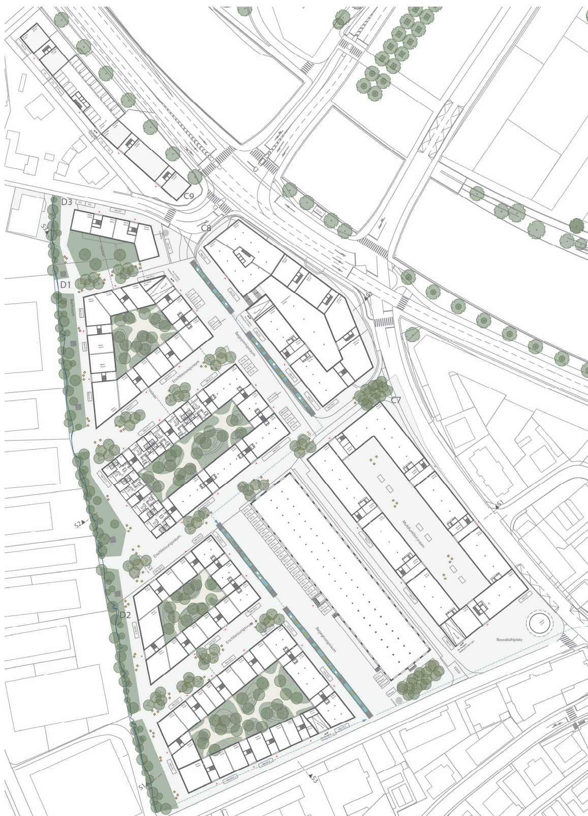
Grundriss Erdgeschoss Vollausbau mit Freiraumkonzept
