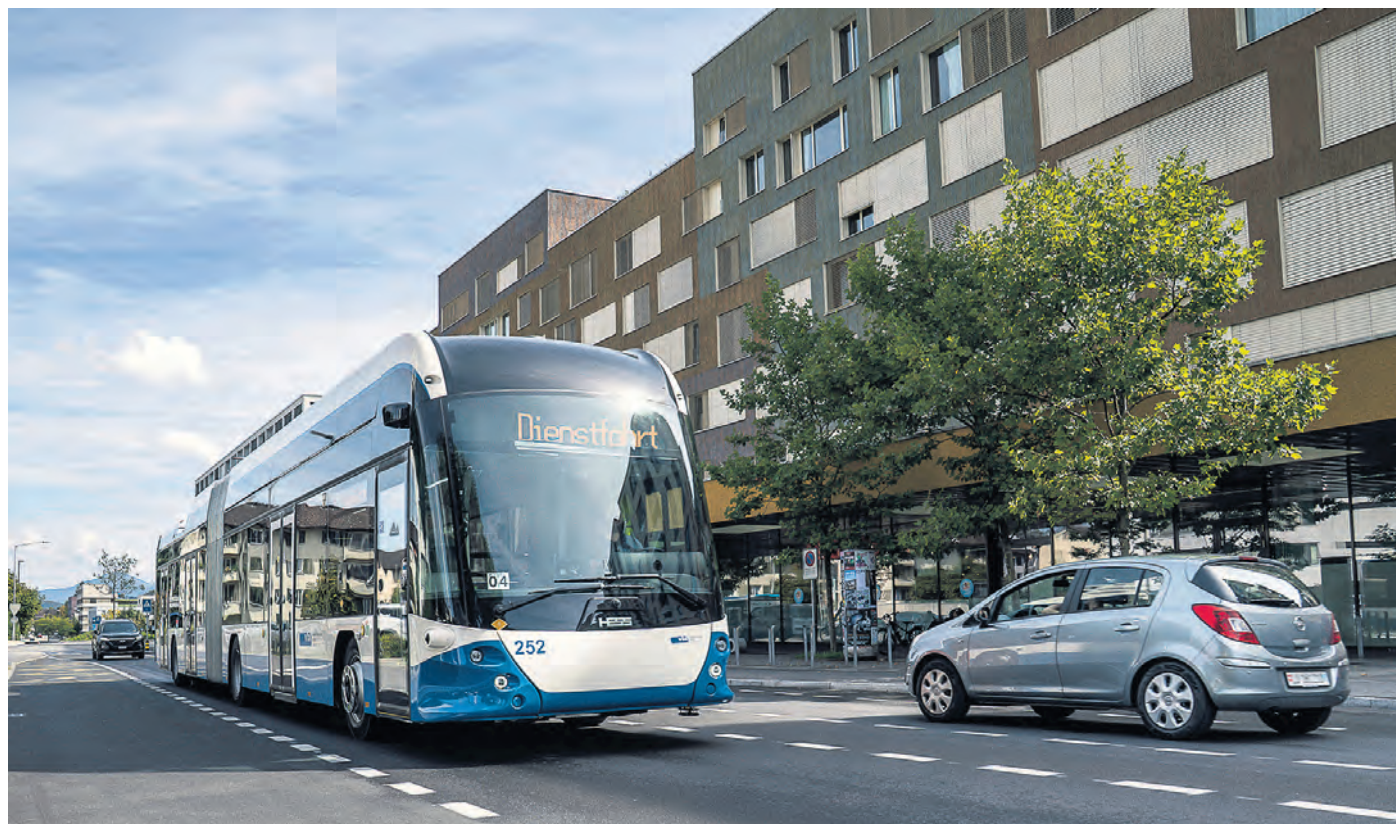
Ein neuer Trolleybus auf Testfahrt in Littau auf einem Abschnitt ohne Fahrleitung. Die Busse fahren zwischen Michaelshof und Gasshof mit Strom aus der Batterie. Die Stromabnehmer bleiben deshalb eingezogen. An den Endhaltestellen Bahnhof Littau und Gasshof wird die Batterie geladen.
