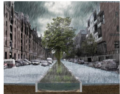
Abbildung 72: Notwasserweg auf Gemeindestrasse 2. Klasse bei Regenwetter, Hamburg DE (Quelle: Freie und Hansestadt Hamburg)
