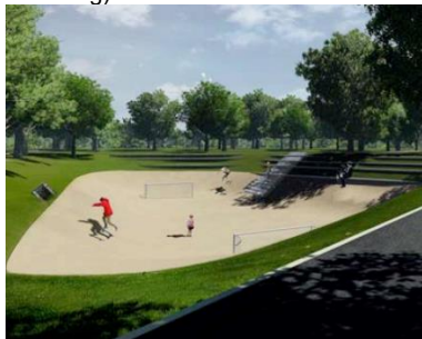
Abbildung 73: Retentionsfläche auf Sportplatz bei Trockenwetter, Wesseling DE (Quelle: MUST)
