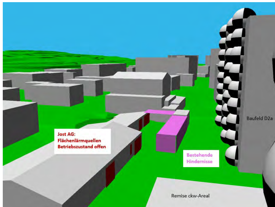
Abb. 28 Näherungsweise Modellierung der bestehenden Hindernisse (offene Unterstände auf Areal Jost AG und Areal CKW plus bestehende Remise auf Areal CKW) im CadnaA
