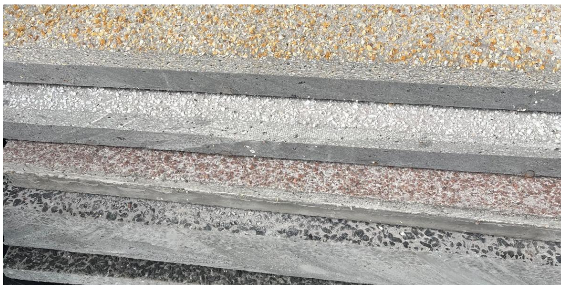
Abbildung 42 UHFB mit Splittmatrix - Beispielplatten
