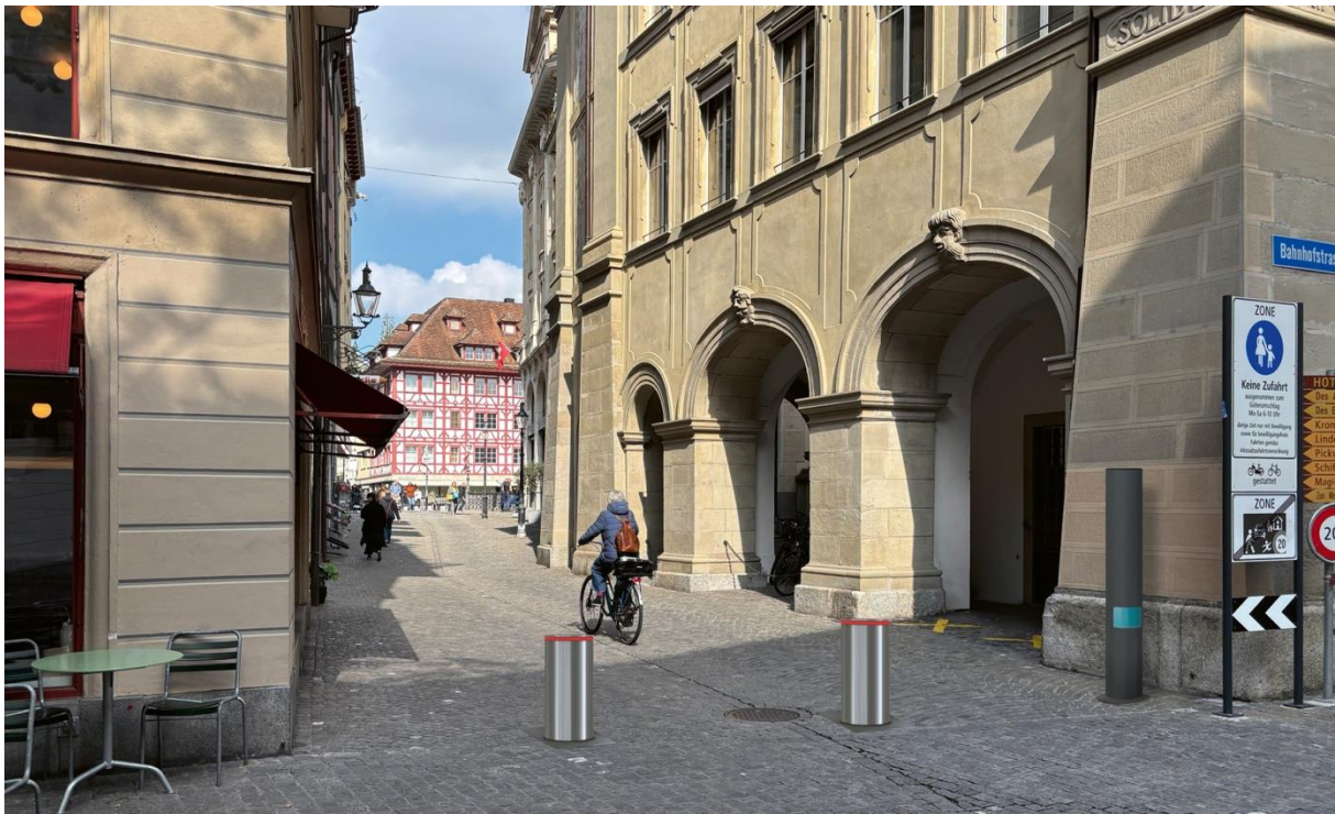
Abb. 10: Visualisierungen der Senkpolleranlage bei der Krongasse
