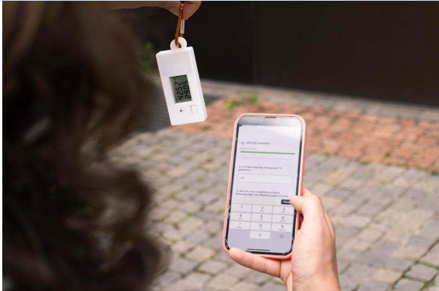
Abbildung 2 - Ausgerüstet für die Datenerhebung: mobiles Messgerät für Lufttemperatur (SHT4x SmartGadget, Sensirion) und 3-2-1 heiss! App von NOA
