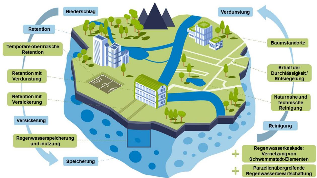
Abbildung 2: Naturnaher Wasserkreislauf mit Schwammstadt-Elementen (grün) und deren Funktionen (blau). (Quelle: HOLINGER AG angepasst nach Verbändeoperation Wassersensibles Planen & Bauen, Bayern DE)
