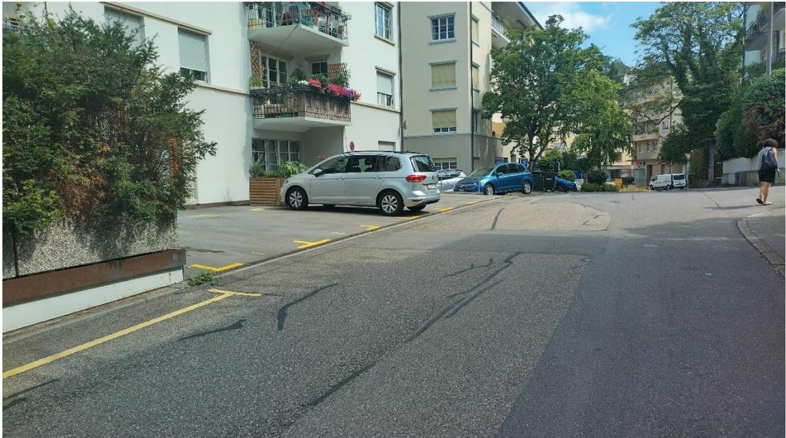
Abbildung 16 Senkrechtparkierung; Die Sichtweiten an Knoten sind ebenfalls teilweise nicht eingehalten.
