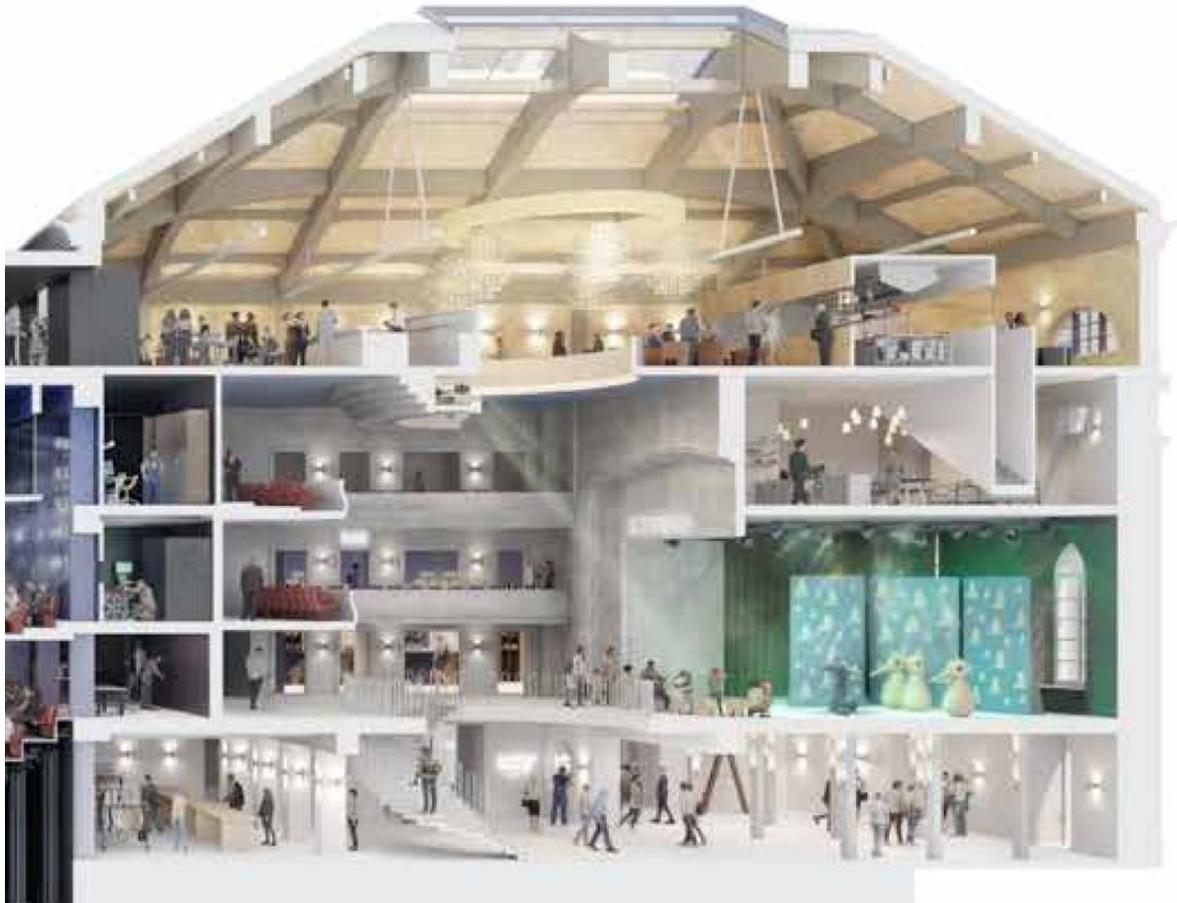
Abb. 8: Schnitt durch das umgebaute, bestehende Gebäude mit Foyer, Studio und Theaterrestaurant
