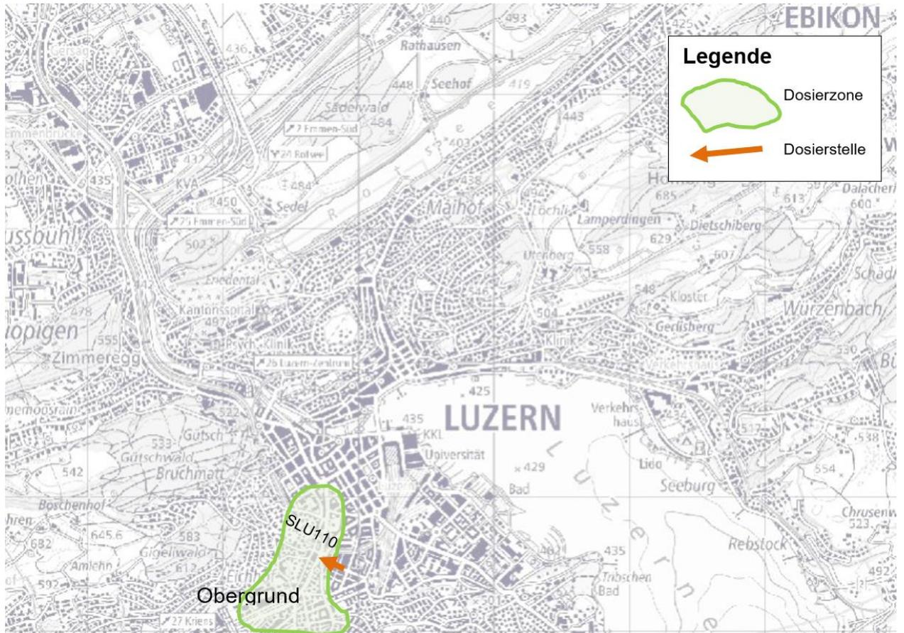
Die Dosierung wird in Abhängigkeit von der Verkehrslage (verkehrsabhängig) geschaltet, d.h. nicht zu festen Zeiten. Bei einer Stautendenz wird das Programm aktiviert. Gemäss untenstehender Abbildung kann eine gewisse Regelmässigkeit ausgemacht werden. Werktags sind in der Dosierzone Obergrund die Dosierungen meist zwischen 16:00 und 19:00 aktiv.
