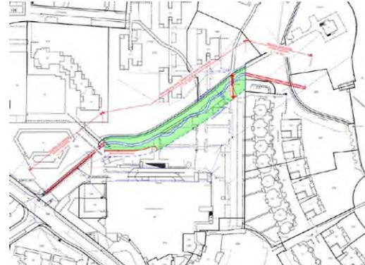
Abbildung 39: Empfohlene Variante Bachverlegung
