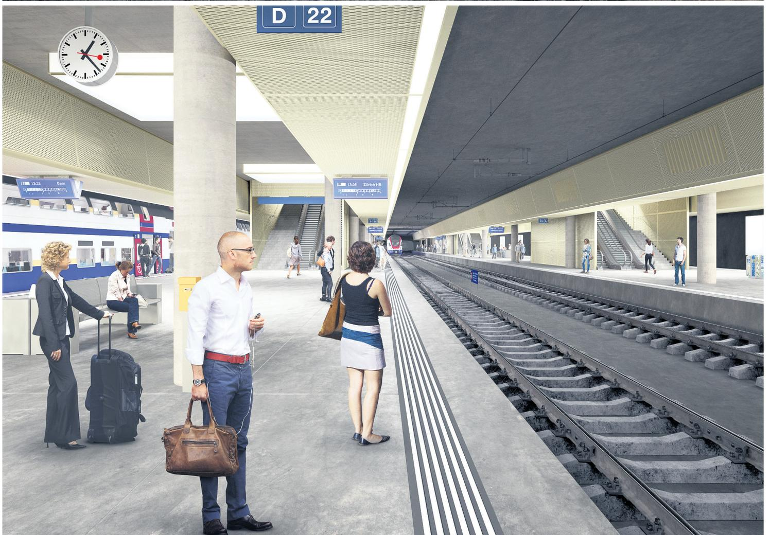
Der Tiefbahnhof ist im zweiten Untergeschoss mit vier Gleisen und zwei 420 Meter langen Mittelperrons geplant (unten). Im ersten Untergeschoss (oben) wird eine Verteilebene gebaut, über die die Reisenden zu den Abgängen und zu den Perrons gelangen.
