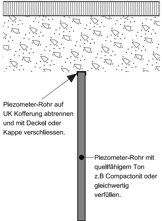
Piezometer-Rohr auf UK Koffering abtrennen und mit Deckel oder Kappe verschliessen.
