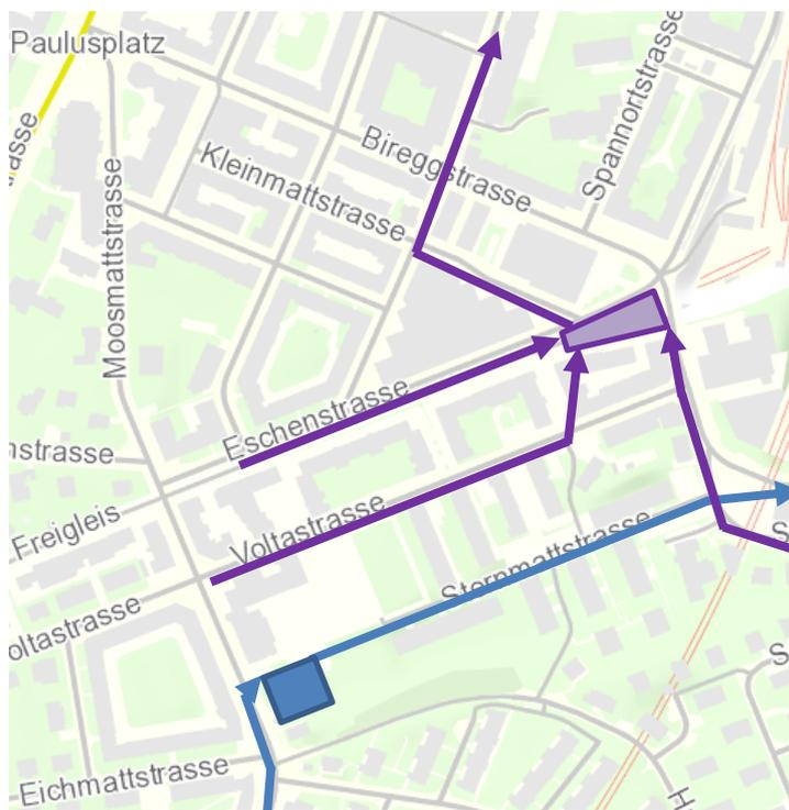
*Violett: Regenrückhaltebecken Eschenstrasse mit Zu- und Abfluss der Kanalisation.*
