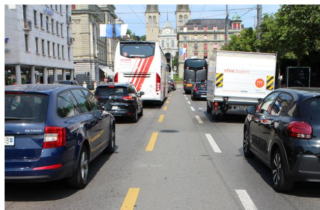
Radstreifen in der Mitte zweier Fahrstreifen des MIV sind bei mittleren und hohen Belastungen sowie bei erhöhtem Schwerverkehr- und ÖV-Anteil unangenehm.
