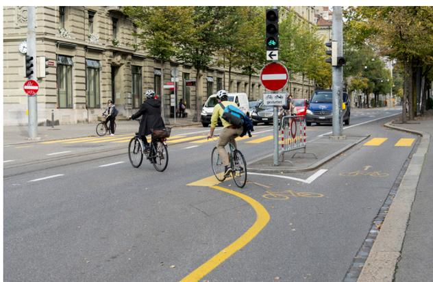
Bei Fussgängerübergängen ist der Einbau einer Schutzinsel zu prüfen. Dies stellt sowohl für Zufussgehende wie auch für den Veloverkehr (bei LSA unabhängige Durchfahrt) eine gute Lösung dar. Beispiel: Bundesgasse, Bern.
