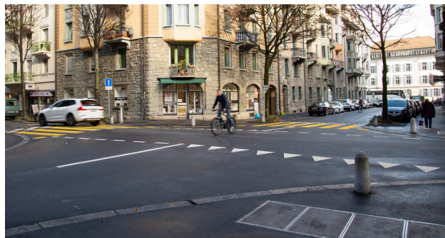
Bruchstrasse, Luzern; Verhinderung von störendem oder gefährlichem Parkieren oder Halten auf der Fussverkehrsfläche und Erhöhung der Aufmerksamkeit auf die Querungsstelle.
