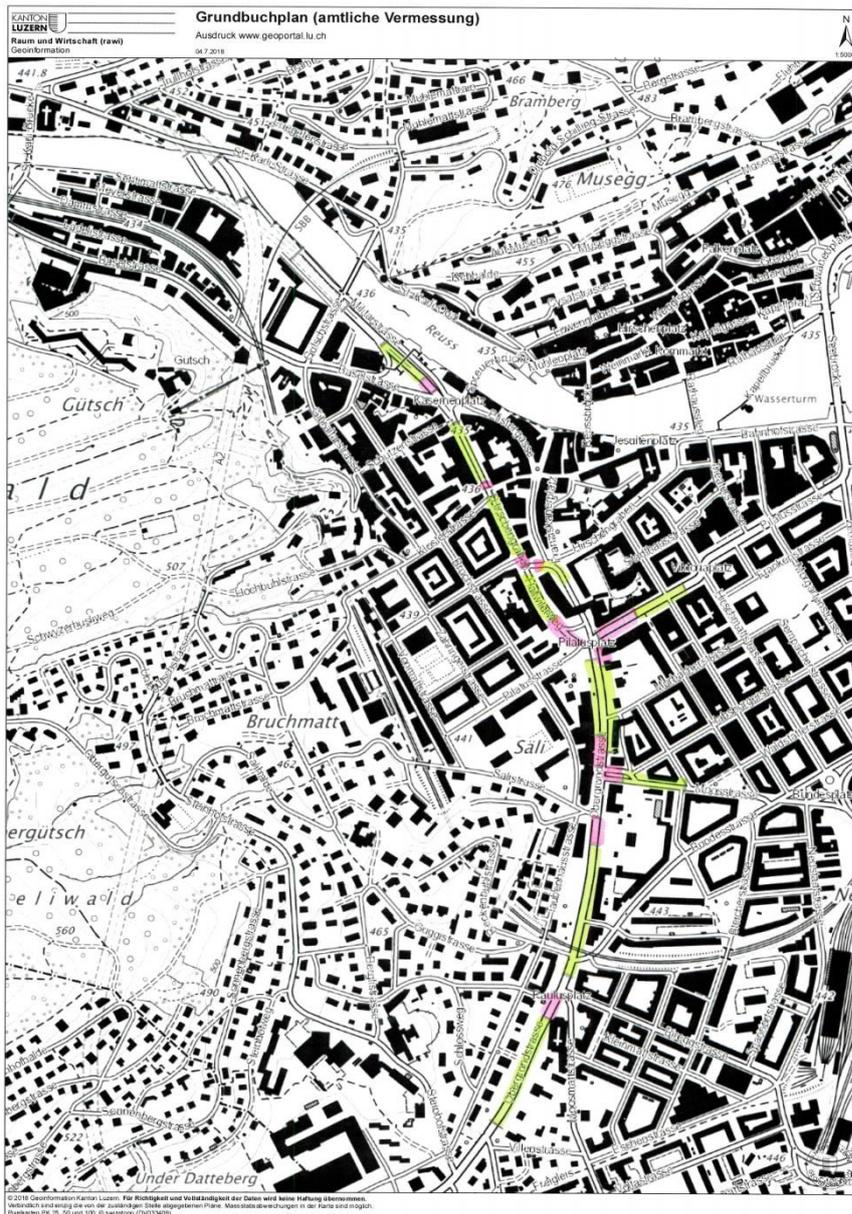
Abbildung 13: Rückstaulängen auf den Hauptverkehrsachsen beim Ist-Zustand, überarbeiteten Vorprojekt sowie Variante A (rot durchschnittliche Rückstaulänge, hellgrün maximale Rückstaulänge)
