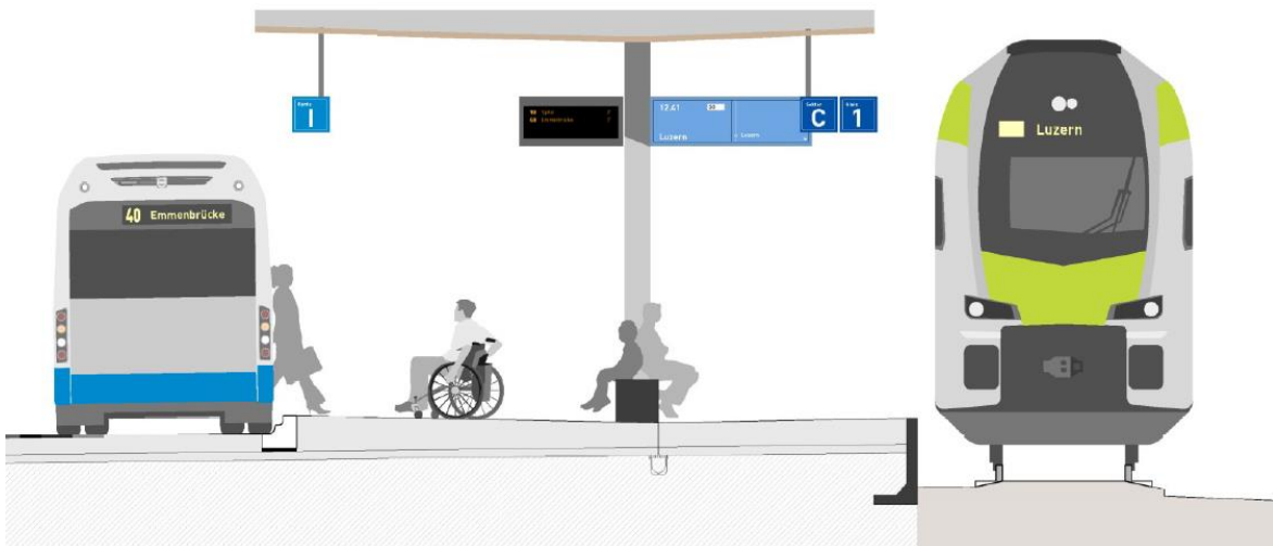
Schema gemeinsames Perrondach Bahn- und Bushaltestelle
