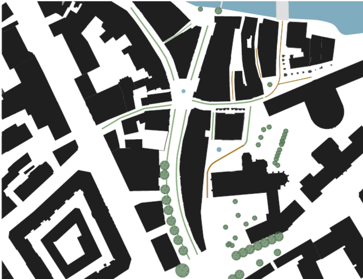
Abb. 11: Konzept der Oberflächenentwässerung mittels Wasserrinnen als Führungselement bzw. als taktile Führung für Sehbehinderte. Legende: braun = bestehende Rinnen / grün = neue Rinnen an der Oberfläche
