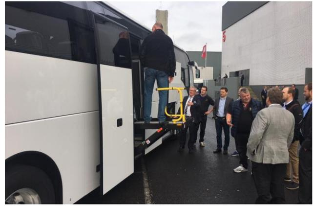
Hubvorrichtung eines Single-Liner Carfahrzeugs
