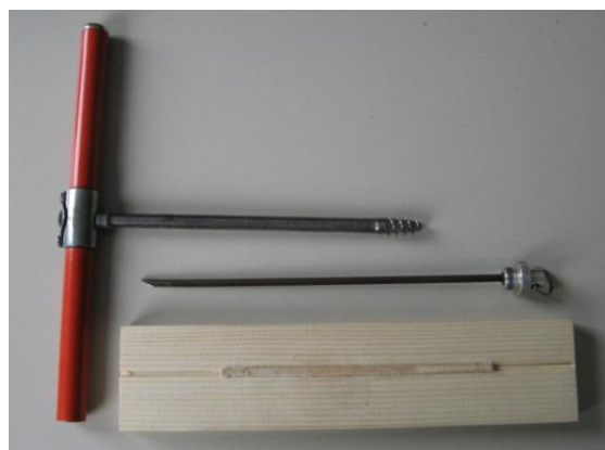
Hohlbohrer mit "Löffel" und Bohrkern, auf Holzstück befestigt
